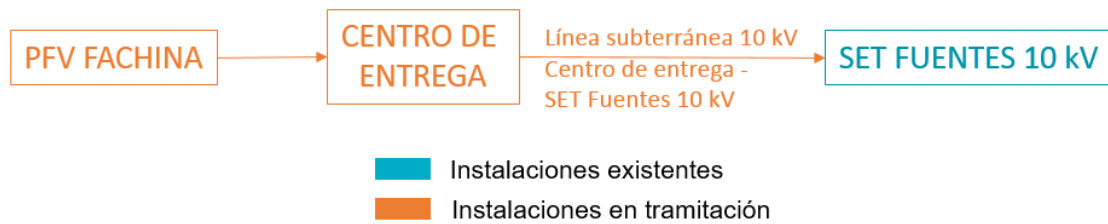
Ilustración 1: Infraestructuras de evacuación
