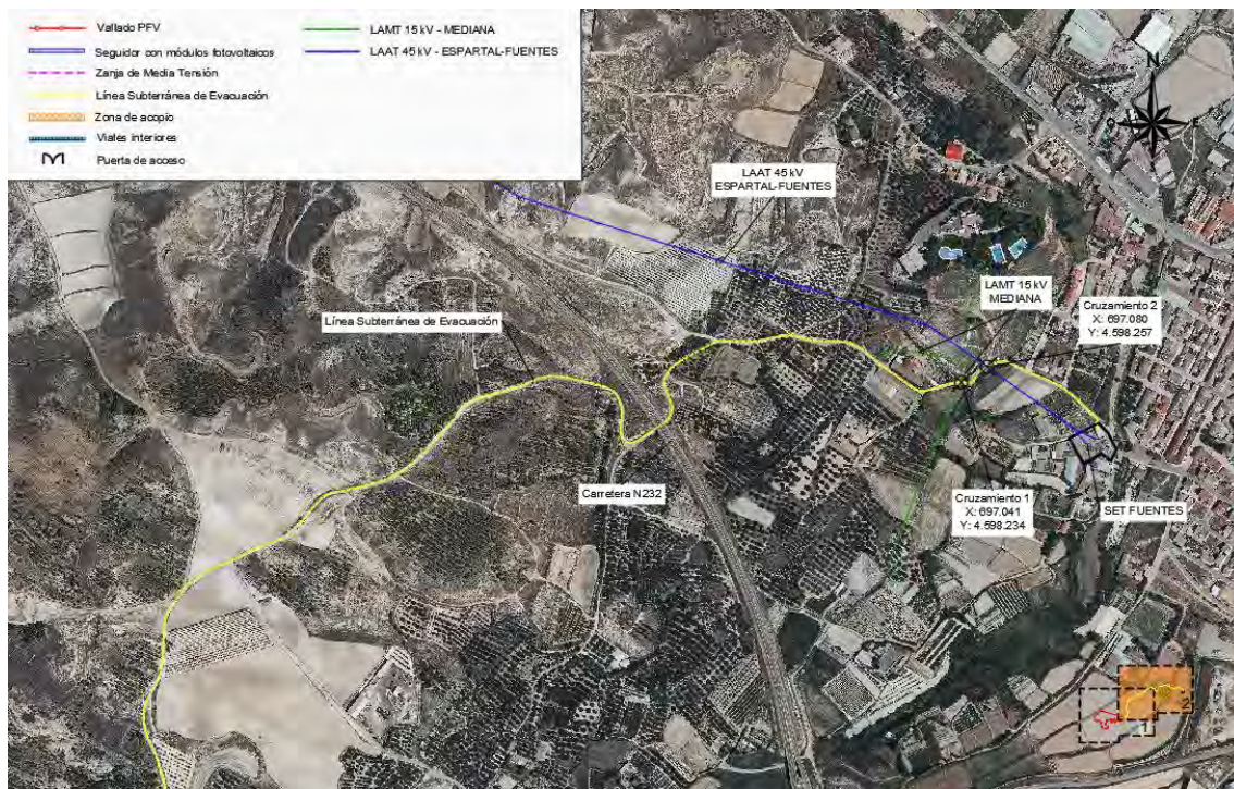
Ilustración 3: Cruzamientos LSMT Fachina y LAAT E-Distribución
