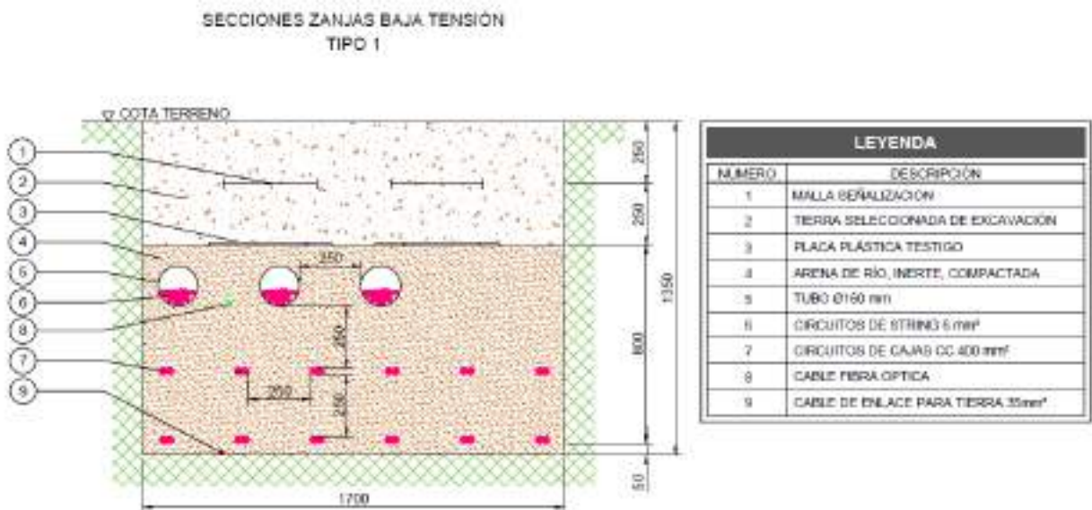
Ilustración 1 Zanja de BT CC
