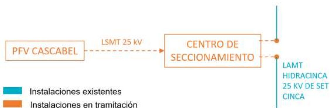
Ilustración 4: Infraestructuras de evacuación
