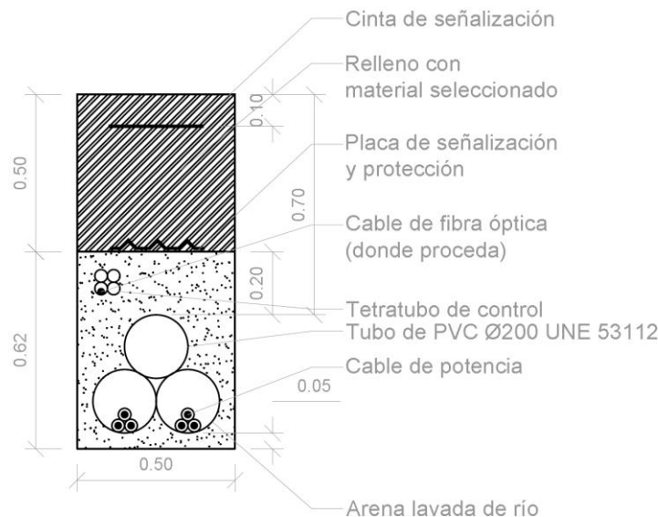
Ilustración. Zanja para tramo Entrada y Salida
