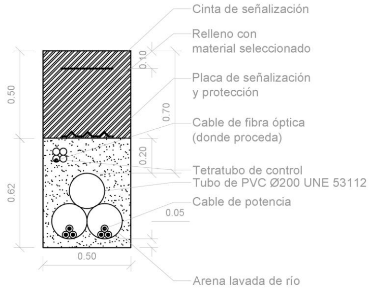
Ilustración. Zanja para tramo Entrada y Salida
