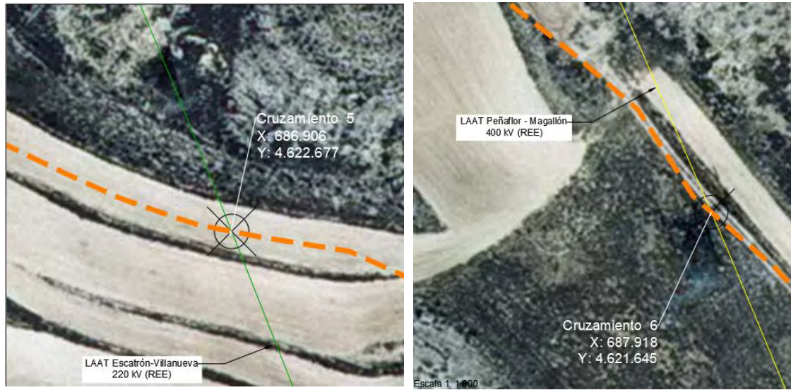
Ilustración 4: Cruzamiento RSMT con LAAT Peñaflor Magallón 400 kV (izquierda) y con LAAT Escatrón – Villanueva 220 kV (derecha).
