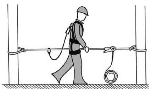
b) Línea de anclaje provisional de cinta
