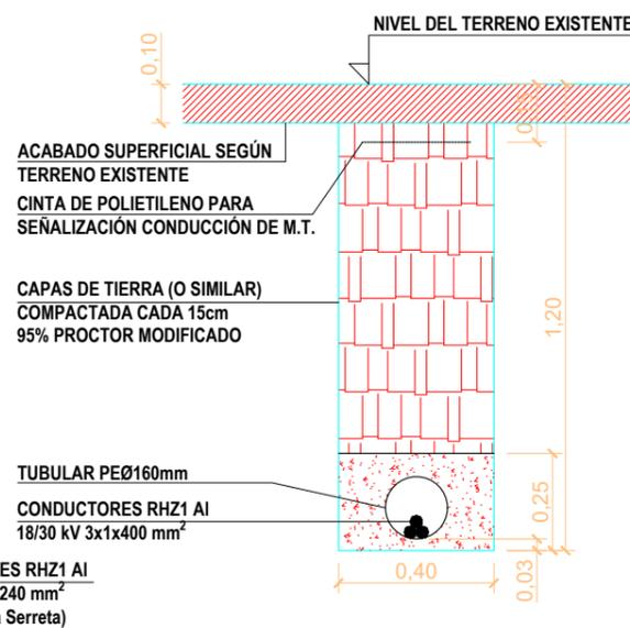
**DETALLE 4 - CONDUCCIÓN SUBTERRÁNEA M.T. BAJO TUBO EN CRUZAMIENTO CON OTRAS INSTALACIONES NO ESPECIFICADAS EN PLANO - DOBLE CIRCUITO**
