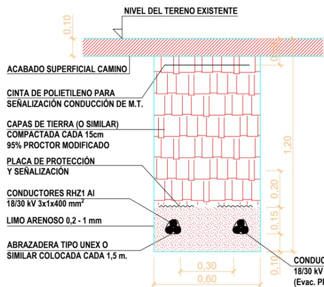
**DETALLE 3 - CONDUCCIÓN SUBTERRÁNEA M.T. BAJO TUBO EN CRUZAMIENTO CON OTRAS INSTALACIONES NO ESPECIFICADAS EN PLANO - SIMPLE CIRCUITO**
