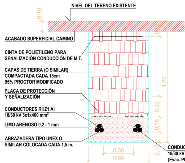
**DETALLE 3 - CONDUCCIÓN SUBTERRÁNEA M.T. BAJO TUBO EN CRUZAMIENTO CON OTRAS INSTALACIONES NO ESPECIFICADAS EN PLANO - SIMPLE CIRCUITO**
