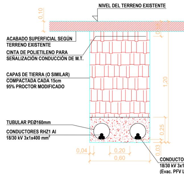
**DETALLE 5 - CONDUCCIÓN SUBTERRÁNEA M.T. BAJO TUBO EN CRUZAMIENTO CON TUBERÍA DE RIEGO EXISTENTE**
