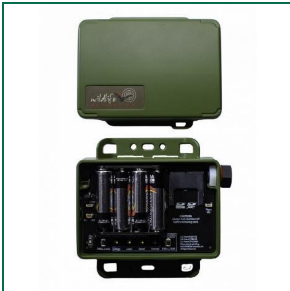
Figura 8. Mini Bat: vista del interior (a) y del exterior (b). Fuente: WildLife Acoustics.
