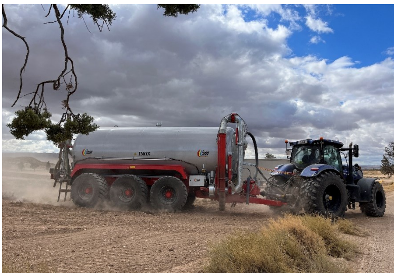
Figura 4 Cuba para la realización de riegos
