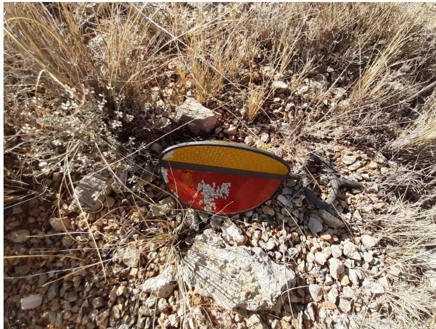
Fig. 1. Baliza salva-pájaros en el suelo, y puntos marcados en el cable toma-tierra donde faltan estas balizas.
