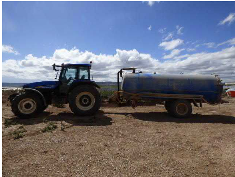
Figura 20. Cuba de agua disponible en la obra que podría utilizarse en caso de registrarse un conato de incendio
