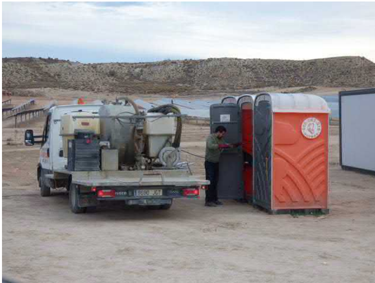
Figura 9. Las aguas residuales generadas en los baños químicos portátiles son retiradas y gestionadas por la empresa propietaria de los mismos
