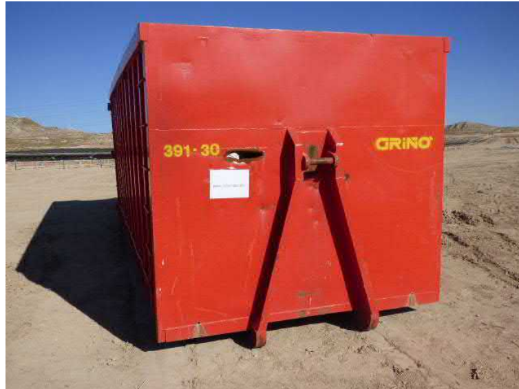
Figura 49. Contenedor identificado mediante cartelería para el depósito de residuos de obra no peligrosos (madera, plástico, metal, etc.)
