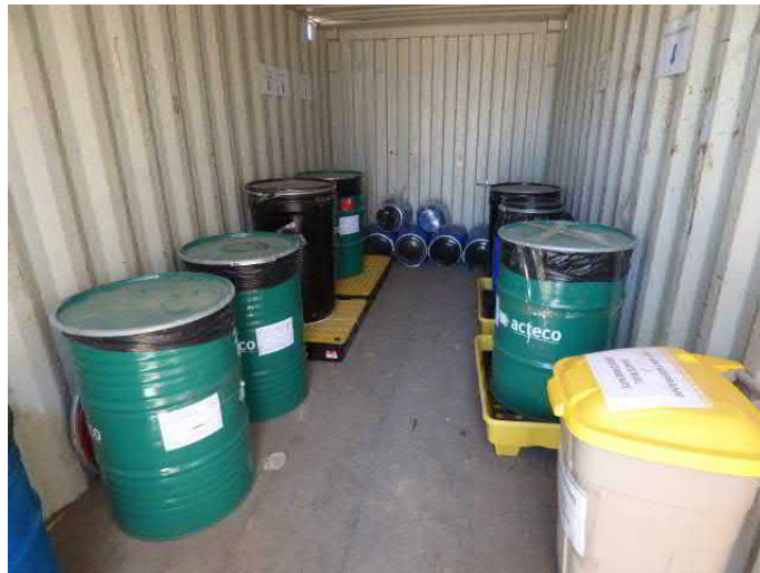
Imagen 33: Depósitos homologados e identificados conforme a la normativa vigente para el almacenamiento temporal de residuos peligrosos
