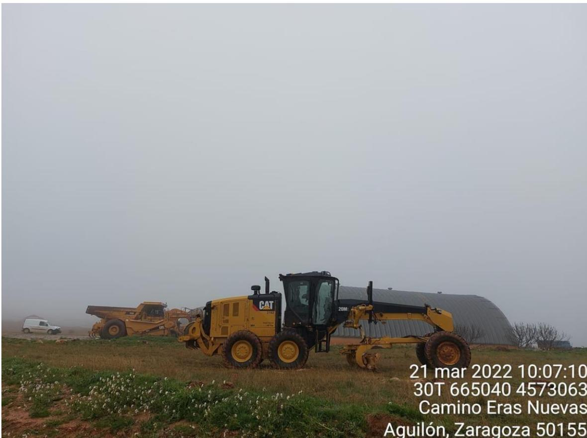
Imagen 3. Maquinaria parada debido al mal estado de los viales por la lluvia.
