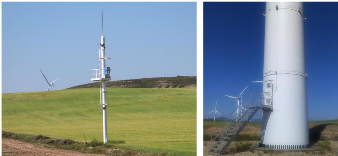
Figura 4: Fotografías del Sistema “3D Observer” ubicado junto al aerogenerador LLo7 (izquierda) y del Sistema “DTBird” instalado en el aerogenerador LLo8 (derecha).
