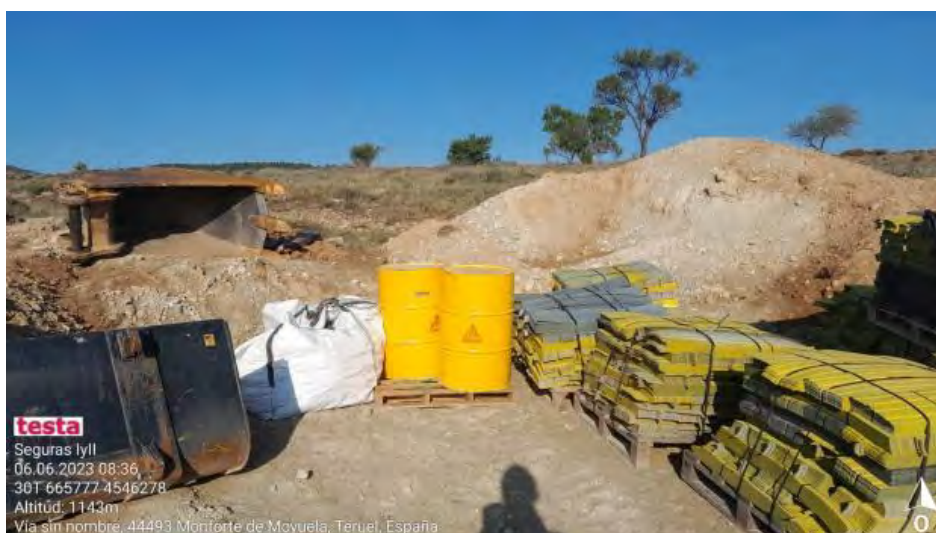
Líquido detectado sin aislamiento.
